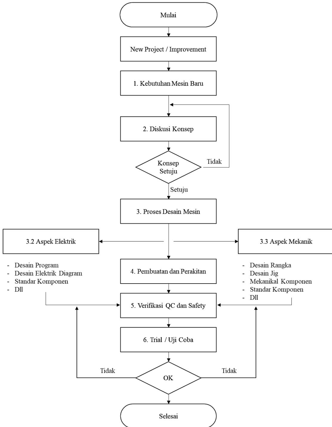
**Gambar 3. Flow chart pembuatan Special Purpose Machine**
