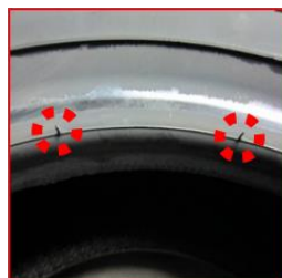
Gambar 10. Ilustrasi Hasil Perbaikan Vent Hole Bead Ring
