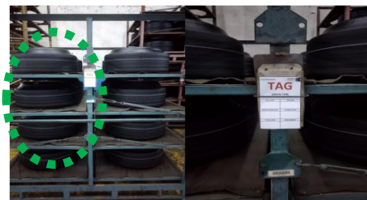
Gambar 12. Ilustrasi Rak GT Telah Ditempel TAG
