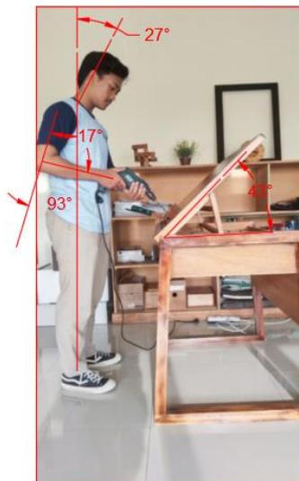
Gambar 5. Postur Kerja Perbaikan Pada Proses Perakitan dan Hasil Ukur Sudut Tubuh
