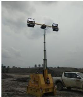
Gambar 1. Lampu LED NL500A terpasang pada *tower lamp*.
