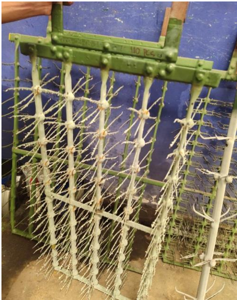
Gambar Keadaan Jig Lama (Jig Berkarat dan Mengelupas)
