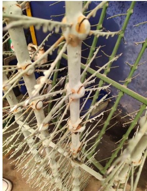
Gambar Keadaan Jig Lama (Jig Berkarat dan Mengelupas)
