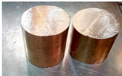
**Gambar 13. Materil penutup silinder pompa**
