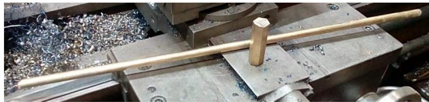
Gambar 15. Material batang piston dan mur pompa
