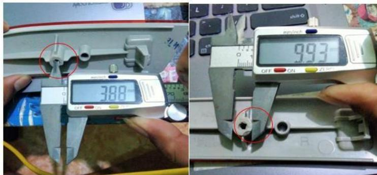
Gambar 2. Dimensi lubang lampu reflektor
