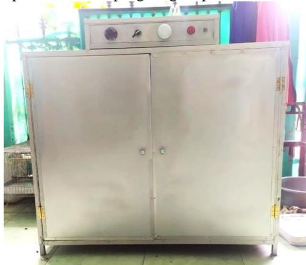
**Gambar 2.** Hasil Pembuatan Alat Pengering Biopelet
