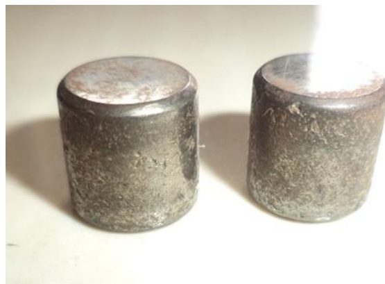
Gambar 1. Kerusakan Roller pada Bantalan Gelinding
