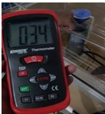
Gambar 7. Aktual pengukuran T1 (permukaan insulasi)
