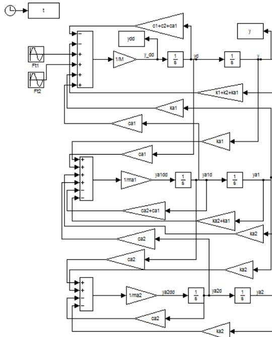
Gambar 3. Diagram Blok DDVA tersusun seri
