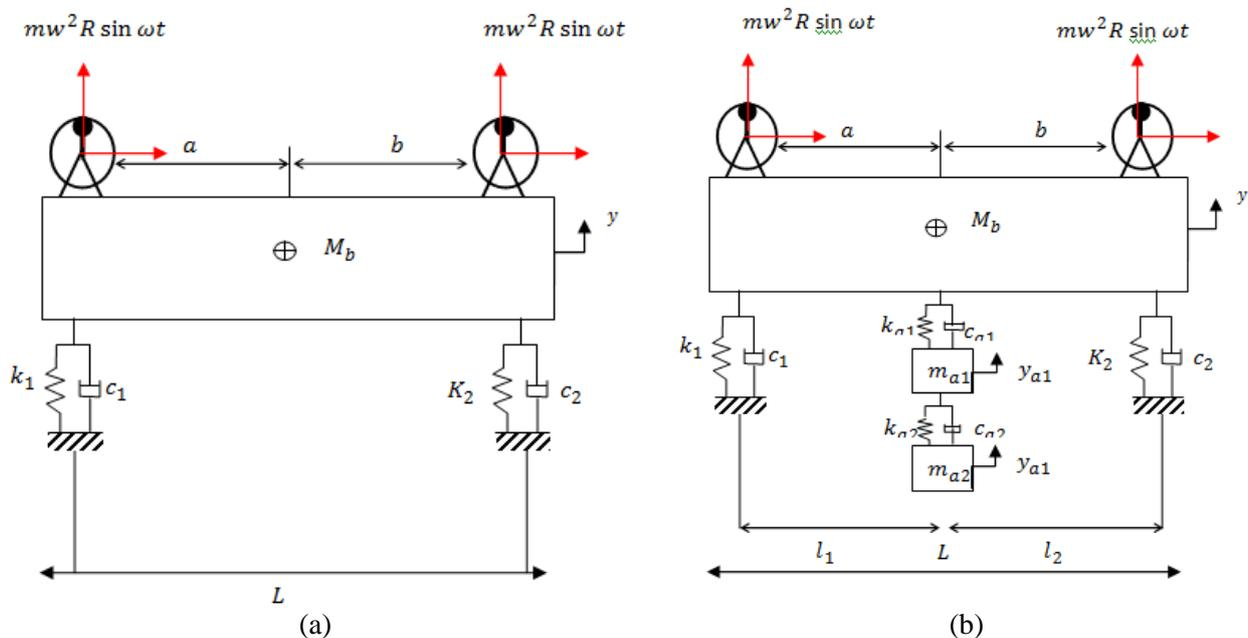
Gambar 1. Model sistem (a) TDVA dan (b) DDVA
