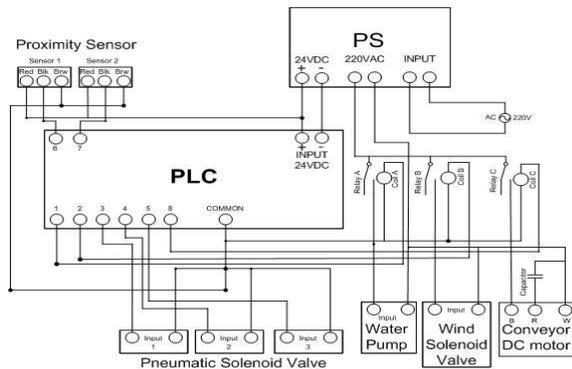
Fig. 14. Circuit Diagram
