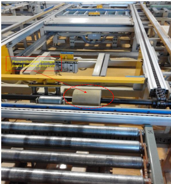
Gambar 6. Setelah Dilakukan Penambahan Sponge pada Shaft Roller Conveyor (Additional 1)
