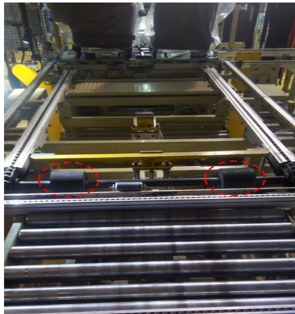
Gambar 10. Setelah Dilakukan Penggantian Sponge Dengan Menggunakan Material Dari Bahan Karet (Additional 2 sponge)
